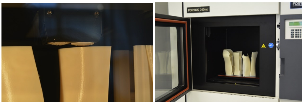
Obr. 9: Zkušební tisk na FORTUS 360 mc v 3Dees
