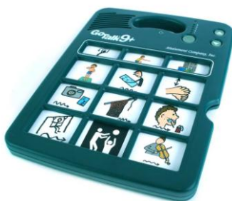
Obr.2: GoTalk 9+ - komunikační pomůcka s hlasovým výstupem pro 5 tabulek s devíti obrázky
