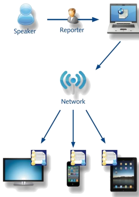
Obr. 2: Základní schéma fungování systému Polygraf
