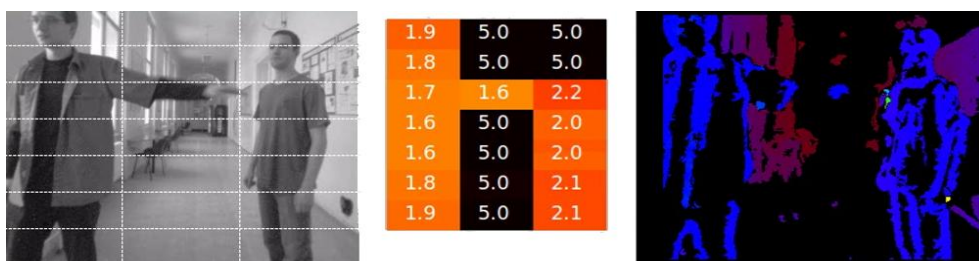
Obr.2 Příklad detekce horizontální úzké překážky
