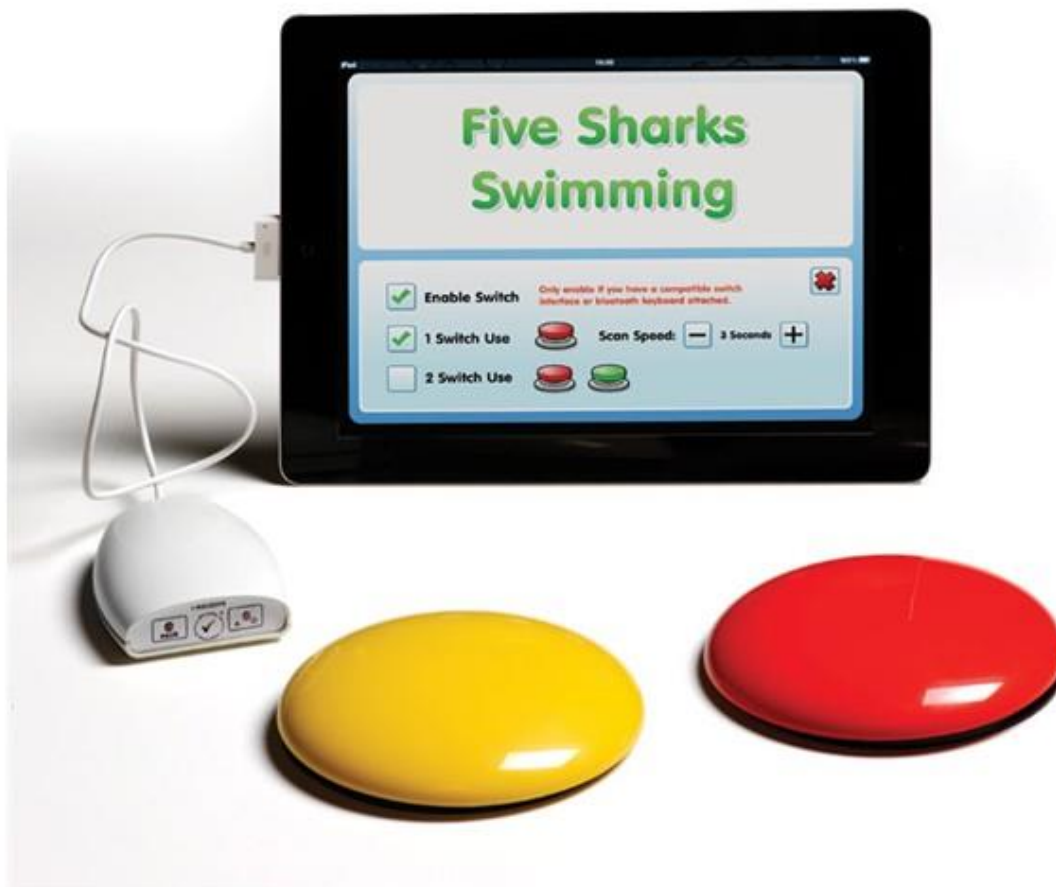
Obr. 1: Ovládání aplikace pro iPad dvěma externími spínači
